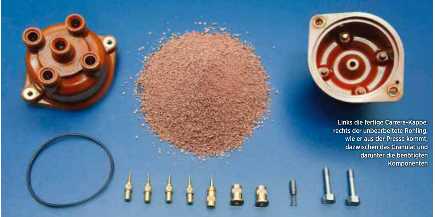
Die Stempel fixieren die Messing-Einbauten während des Pressvorgangs
