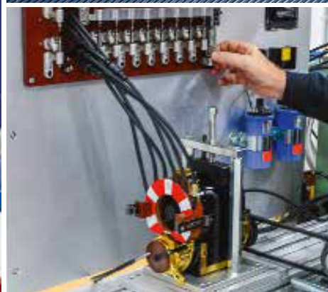
Lass knacken: Der Magnetzündler-Prüfstand ist Roland Merz' neueste Errungenschaft
