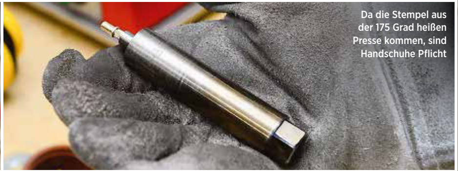
Allein die Anfertigung des aus hochlegiertem Stahl hergestellten Gesenks verschlingt rund 20.000 Euro
